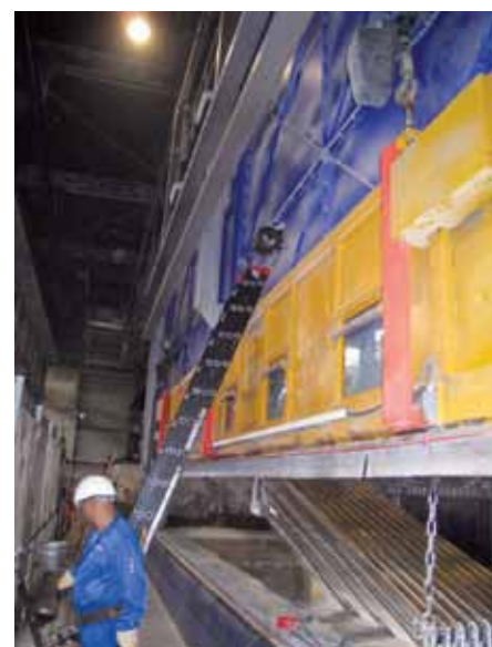
Thermisch zinkbad met sluitbare mantel. (Foto: To Improve)
