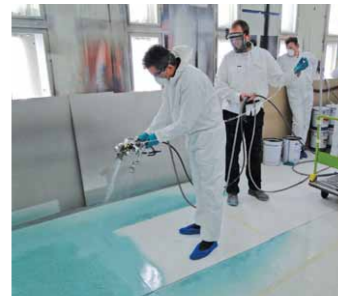
Twee nozzles spuiten diagonaal de lak op, en waar de lakstromen samenkomen wordt een versnipperde glasvezel gedoseerd. De deelnemers mochten het zelf ook proberen.
