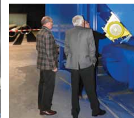
Het enorme gevaarte was de hoofdact van de rondleiding. Grote objecten zijn in enkele minuten ontlakt en van een ankerprofiel voorzien in de werpstraaltunnel.
