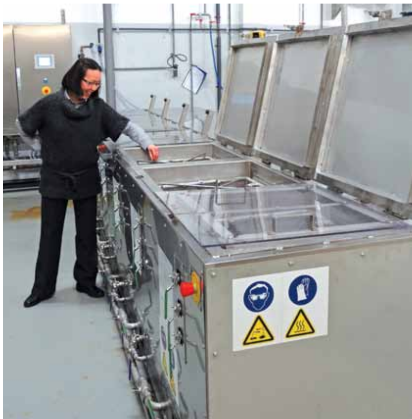
Christine Lai Cao bij de nieuwe baden, waaronder een ultrasoonbad dat tot 130 graden Celsius gaat. Aluminium kan ontlakt worden in een sproeitoepassing. Dompelen met veel agitatie (badvloeistofbeweging) is ook mogelijk. Let ook op de transparante tussendeckels op de baden.
