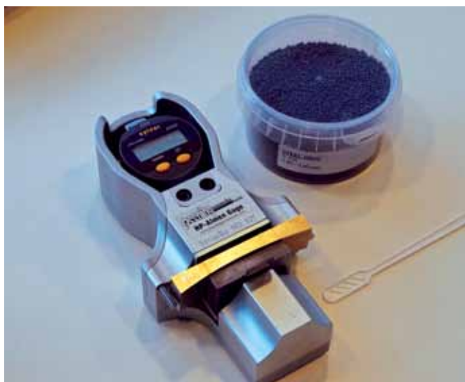
Almentester: een geschotpeend plaatje wordt op doorbuiging bemeten zodat vooraf de shotpeenparameters optimaal ingesteld kunnen worden.
