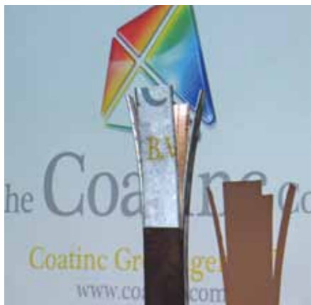
Een in het zinkbad opengesprongen koper.
