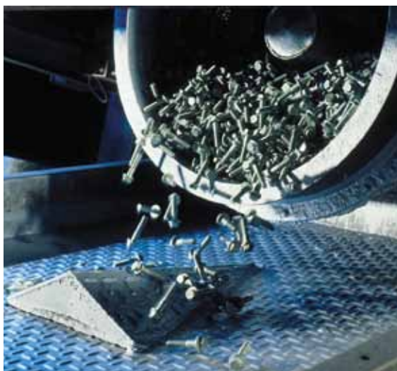
Bouten en moeren moeten tegen vastroesten beschermd worden. Maatvastheid en dus laagdiktebeheersing zijn belangrijke vereisten.
