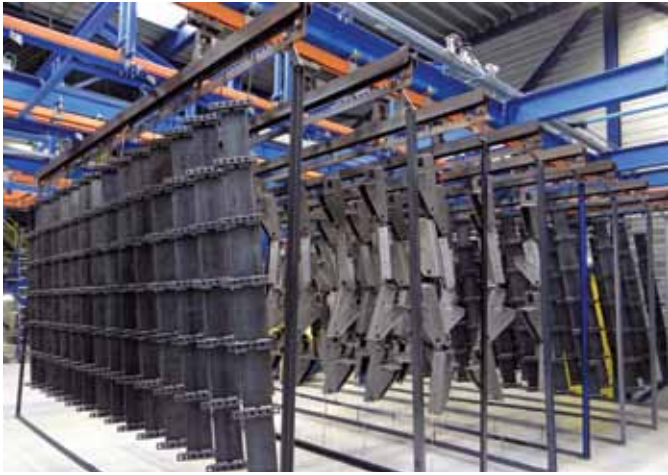
In de goed verlichte hal met bijbehorende lichte vloer worden op diverse plaatsen de werkstukken pasklaar gebufferd, voor en na de diverse verduurzamingsbehandelingen.
