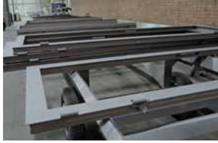
Stalen deurkozijnen voorafgaand aan de behandelingen, gestraald en halverwege het schoopeerproces.
