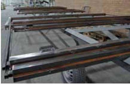
Stalen deurkozijnen voorafgaand aan de behandelingen, gestraald en halverwege het schoopeerproces.
