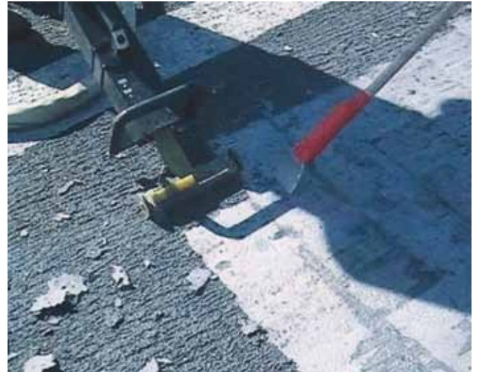
Slijtvaste dekplaten van een vliegtuig worden verwijderd met inductieontlakken. (Foto: RPR Technologies, Noorwegen)
