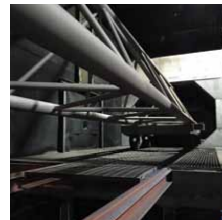
Een heel snelwegportaal schuift in enkele minuten door de zelf ontwikkelde straalinstallatie.
