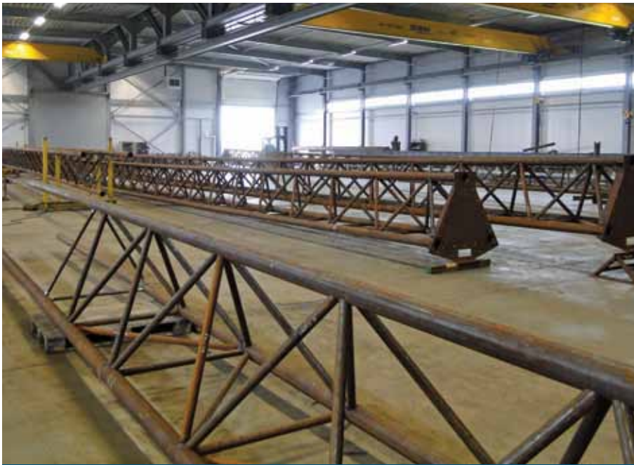
In de enorme hal, met slechts twee kolommen die de overspanning onderbreken, liggen de werkstukken gereed, voorafgaand aan het stralen.
