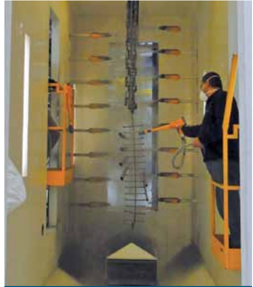
Het combineren van automatisch poedercoaten en handmatig bijspuiten is ook hier gangbare praktijk in de lakapplicatie.
