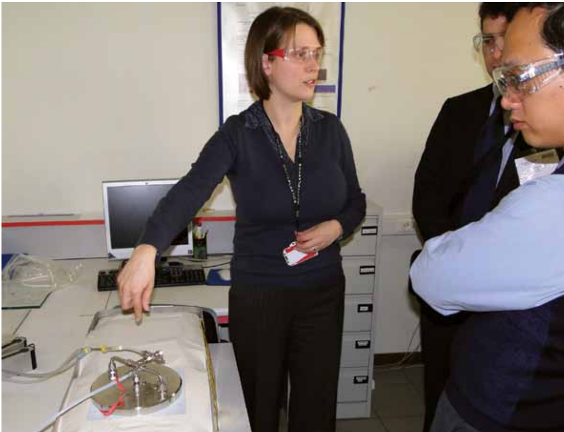
Teamleider Structural Material Characterisation Ann de Vyt geeft een toelichting op de bemonstering van Vluchtige Organische Stoffen van gelakte proefstukken met behulp van een FLEC (Field and Laboratory Emission Cell).
