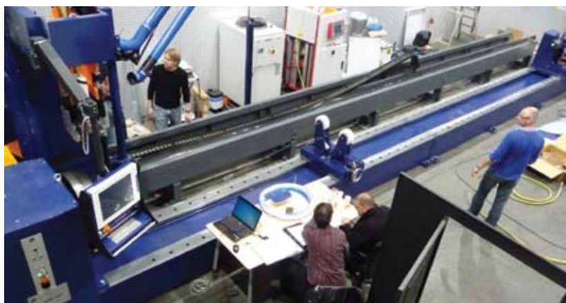
Volledig CNC-gestuurde machine voor het lasercladden van cilindrische delen. (Foto: Technocladding)
