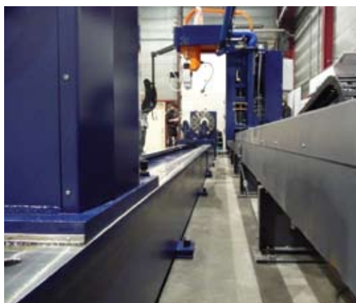
Machine voor cilindrische delen tot 20 meter. (Foto: Technocladding)
