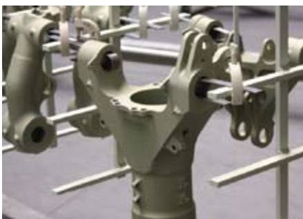
Onderdelen van een landingsgestel. (foto: Surface Treatment Nederland, Maasbracht)
