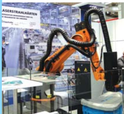
In een hal voor Industrial Supply vertoonde onderzoeksinstituut Fraunhofer, waarvan de ruim vijftig vestigingen in vele hallen vertegenwoordigd waren, het laserstraalharderen.
