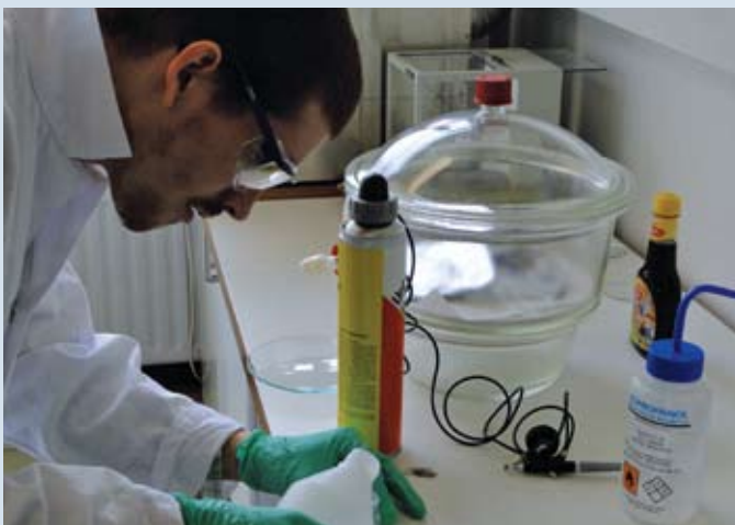
Tijmen maakt de airbrush gereed. Op de achtergrond de strooppot waar praktijkgetrouw een demo mee is gegeven aan bedrijven om de easy-to-clean eigenschappen van de substraten te tonen.
