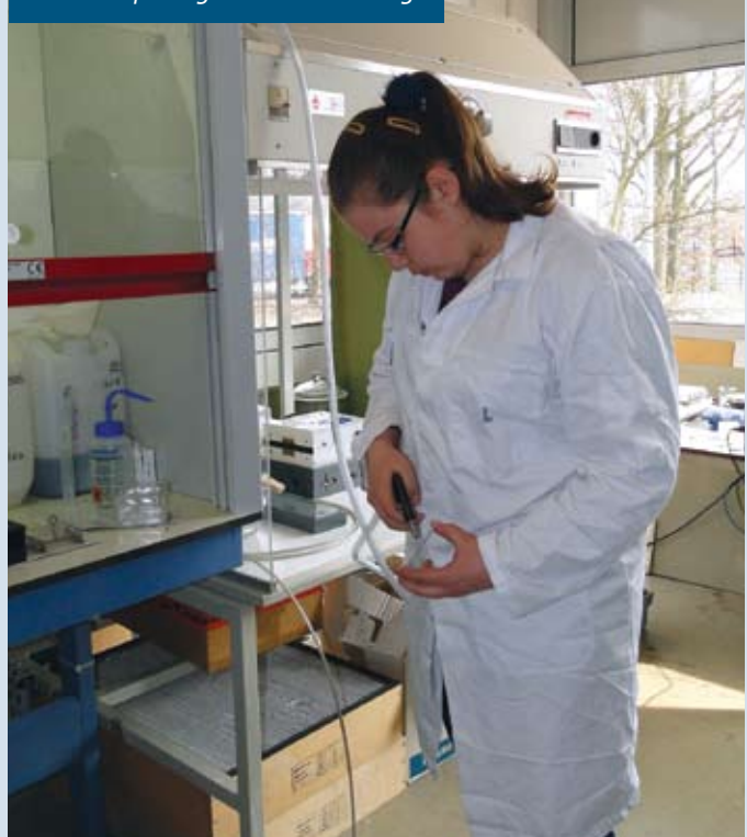
Wendy blaast wat glasplaatjes af voor het opbrengen van een coating.
