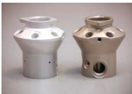
Geanodiseerd brandstofinlaatsysteem (links voor de behandeling, rechts erna).
