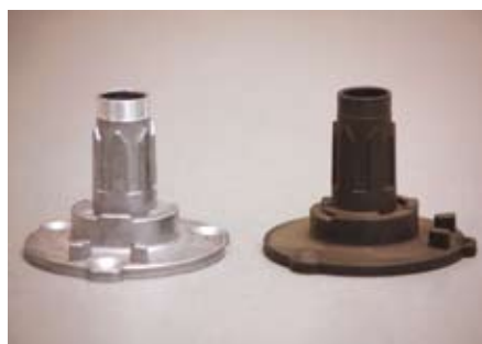
Onderdelen van een elektrisch aangestuurdde spiegel: hardanodiseren plus Surlon KE (links voor de behandeling, rechts erna).
