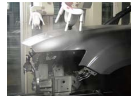
Spuitklokken ('bells') voor watergedragen basecoat; de electrostatische oplading vindt extern plaats via de "sprieten".
