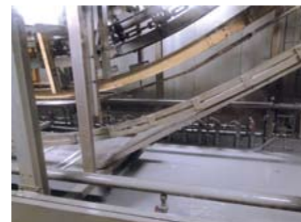
Kataforese dompellakbad voor de electrocoat grondlaag.
