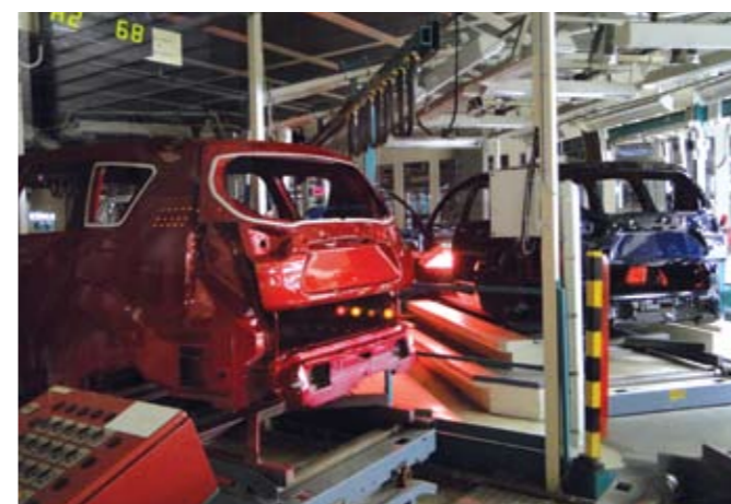
Infrarooduitharding na kleinschalig bijwerken.
