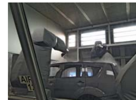
Het pneumatisch aanbrengen van de tweede laag watergedragen basecoat met behulp van robots.
