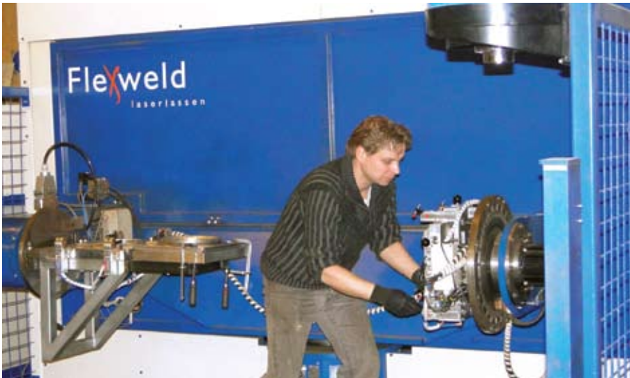
Rene Hofmeijer spant een werkstuk op. Het laseroplasapparaat is in eigen beheer ontwikkeld en gebouwd.
