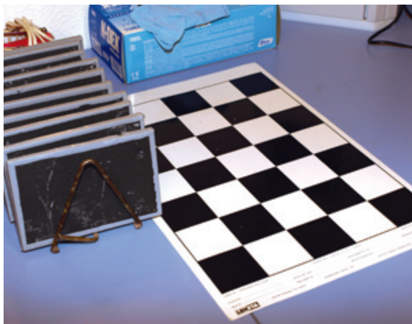
De dekkraft van een lak kan bepaald worden met een “dambord”.
