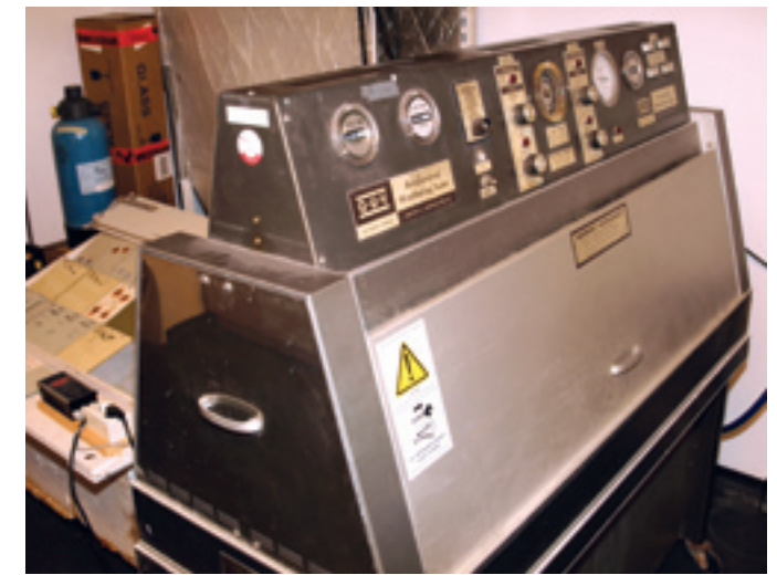
De QUV-test simuleert zonbelasting.
