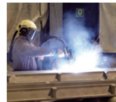
De praktijkdemonstratie metalliseren: na vele jaren van overleg is de verduurzamingstechniek doorgebroken bij opdrachtgevers in de infrastructuur.
