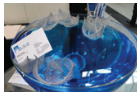
Drijvend staalgaas met ingeschepte lading: waterafstotend door nanotechnologie.
