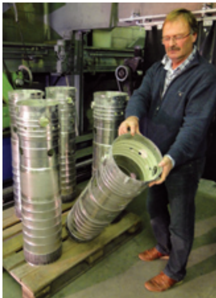
Directeur Ton Kraak toont één van de vele waardevolle toepassingen van thermisch spuiten: Thermal Barrier Coating op liners voor industriële gasturbines. Een warmtewerende plasmagespoten deklaag op basis van yttria-gestabiliseerd zirconia.
