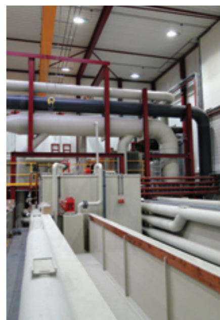
Voorafgaand aan een behandeling wordt het bad leeggemaakt, in het reservoir op de achtergrond wordt de vloeistof op temperatuur gehouden tot de te verchromen as bevestigd is aan de rotatiemotor.
