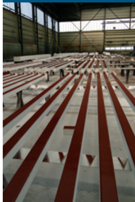
Brandwerende coatings in meerlaagssysteem.
