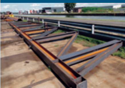
Vakwerkspant na het stralen.
