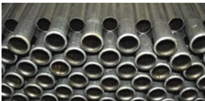
Door ketenafstemming met Corus zijn deze sproeileidingen voor de kassenbouw met minder alkalisch reinigingsmiddel en bij een hogere doorvoersnelheid te coaten.
