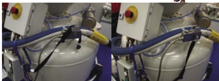
De dodemansknop met magneetverbinding van Straaltechniek International werd voor het eerst gepresenteerd op de Hannover Messe.
