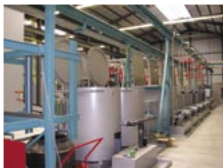
De volautomatische Geomet-lijn. (foto: Thielco Staalindustrie)
