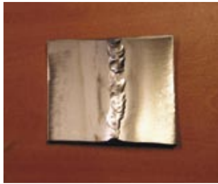
Het effect op de aanloopkleuren van beitsen met verdund salpeterzuur. De corrosievastheid is volledig hersteld.
