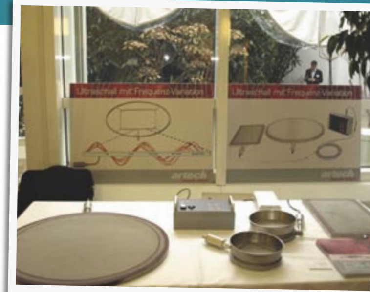
Ultrasoonzeven als onderdeel van de poedersuitinstallatie.
