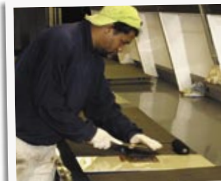
Handmatige selectieve applicatie van de ruthenium- of iridiumgebaseerde elektrokatalytische coating, soms in wel veertig cycli.
