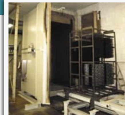
De nieuwe oven met automatische belading.
