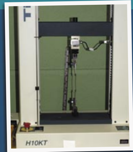
Stretch test voor het vaststellen van de maximale trekbelasting bij diverse ontwerpen.
