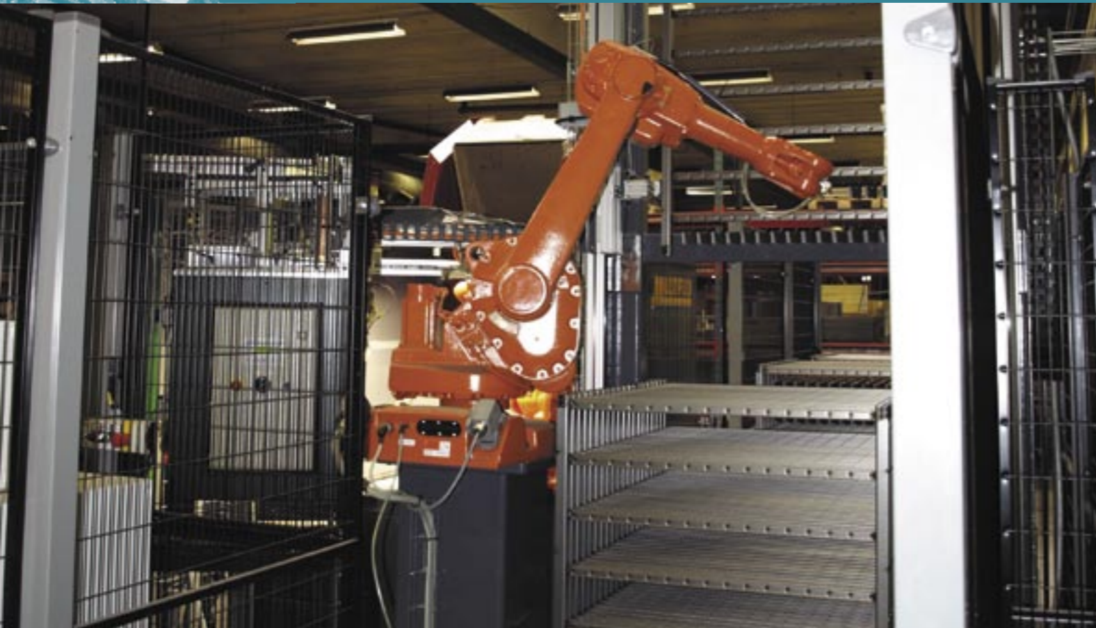
De ophangrobots bij Leba, die onder meer massaal kleine series voor de automotive poedercoat, werden mede omwille van het herhalingskarakter van het inhangwerk aangeschaft, maar droegen ook bij aan een moderner imago bij opdrachtgevers.
